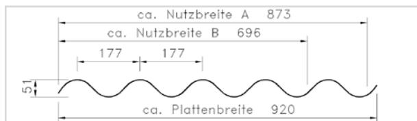
Bei überlappender Verlegung in Wasserlaufrichtung wird Plattenware empfohlen.
